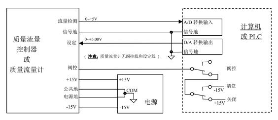
图 12. 直接与计算机连接的接线方法
