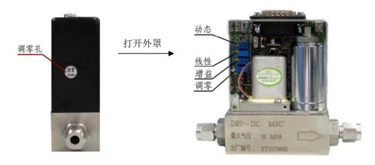
图 13. 11C、11CM 型调零电位器位置图
