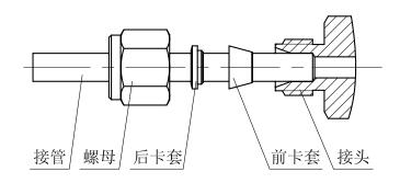
图 5. 双卡套接头安装示意图
