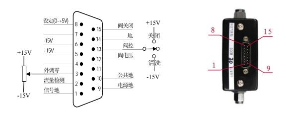
图 9. D07-11C、D07-11E型 MFC的"T式"接线图
