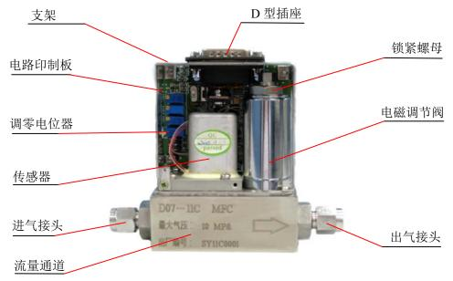
图 2. 质量流量控制器结构图
