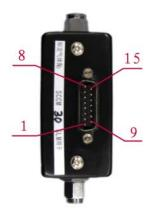
图 10. D07-11CM 型 MFM 的 D 型插座和接线图
