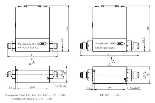
图 4.外形和安装尺寸
