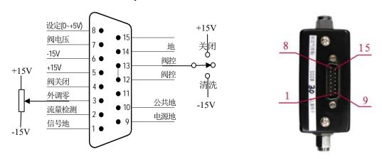
图 7. D07-11C、D07-11E型 MFC的"B式"接线图
