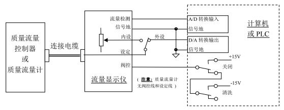
图 11. 通过流量显示仪与计算机的连接
