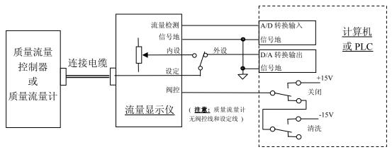
图 14. 通过流量显示仪与计算机的连接
