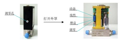
图 17. 12A、12AM 型调零电位器位置图
