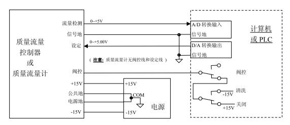
图 15. 直接与计算机连接的接线方法
