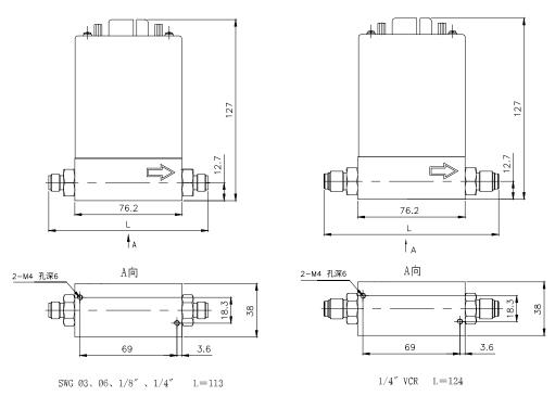
图 4. D07-11、D07-11M、D07-12、D07-12M 型 MFC&MFM 外形尺寸
