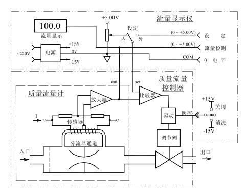
图 3. 质量流量控制器原理
