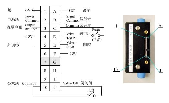
图 8. D07-11/ZM、D07-12/ZM 型 MFC 接线图
