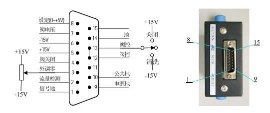
图 10. D07-11A/ZM、D07-12A/ZM 型 MFC 的"B 式"接线图
