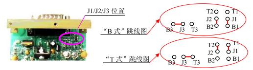
图 11. 12A 型 MFC 插座引线跳线位置图 (11A 型与此类似)
