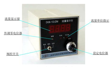
图 18. 流量显示仪操作面板
