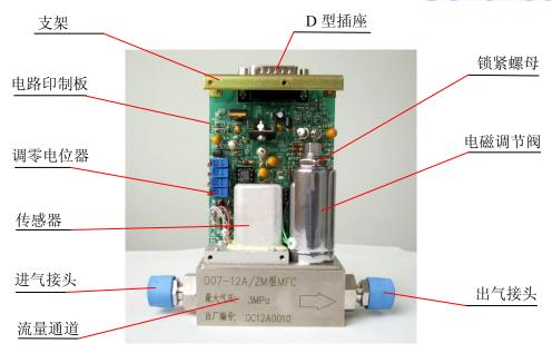
图 2. 质量流量控制器结构图
