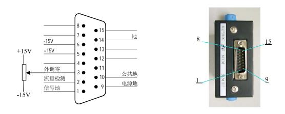
图 13. D07-11AM/ZM、D07-12AM/ZM 型 MFM 的 D 型插座和接线图 11AM、12AM 型质量流量计接线见图 15。它们与 11A、12A 型质量流量控制器的接 线(见图 14)是兼容的, 只是少了阀门控制的几根线。
