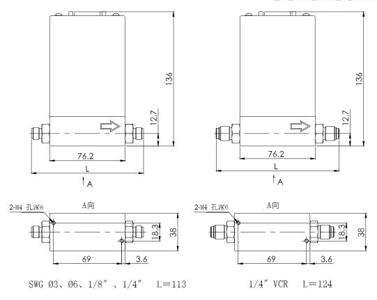
图 5. D07-11A、D07-11AM、D07-12A、D07-12AM型 MFC&MFM 外形尺寸
