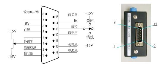
图 12. D07-11A/ZM、D07-12A/ZM 型 MFC 的"T 式"接线图
