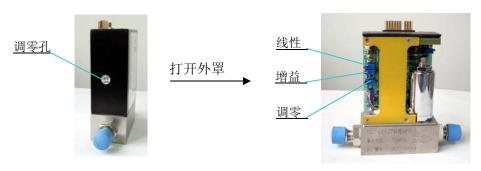
图 16. 11、11M 型调零电位器位置图
