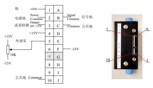
图 9. D07-11M/ZM、D07-12M/ZM 型 MFM 接线图
