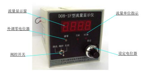
图 12. 流量显示仪操作面板
